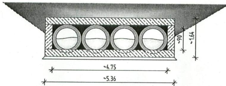
Bereits bei einem 1-jährlichem Hochwasserereignis reicht der Gesamtquerschnitt der Rohrleitungen nicht mehr aus, um den Abfluss zu gewährleisten. In der nachfolgenden Tabelle sind alle Abflussmengen mit den jeweiligen angenommenen Wasserständen und Fließgeschwindigkeiten angegeben.
