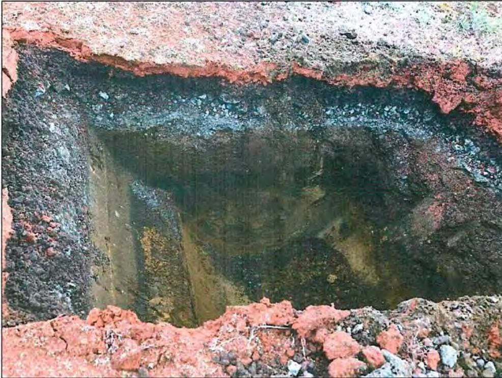
Abbildung 1: Schichtenaufbau Tennisplatzfläche
