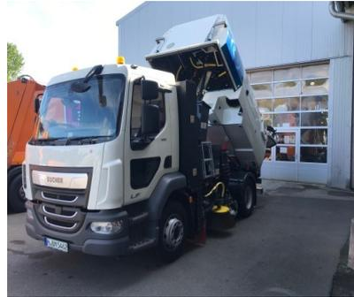
Im Juli d.J. wurde probeweise eine Großkehrmaschine (GKM) mit Elektroantrieb für drei Tage im Stadtgebiet Neumünsters eingesetzt. Die GKM startete die Tour jeweils mit einer zu 100 % geladenen Batterie, am Ende der Tour war diese noch zu über 50 % geladen. Es ist zwar zu erwarten, dass die Batteriekapazität bei kälteren Außentemperaturen und mit den Jahren abnimmt, aber offensichtlich ist eine solche Maschine für den Fuhrpark des TBZ geeignet.
