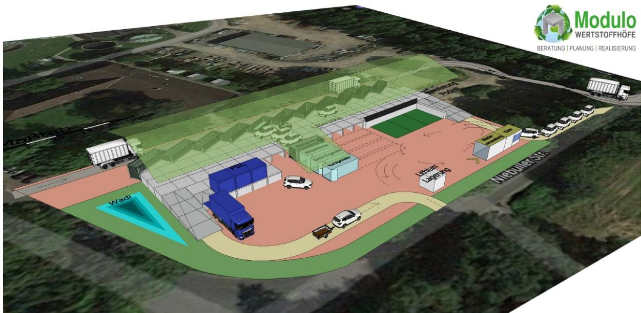
Einfache Sichtprüfung des Containerinhalts durch die Mitarbeiter dank der erhöhten Einrichtung. Die Podesthöhe soll vom Boden aus 1,55 Meter betragen, damit ein einfaches Einwerfen der Fraktionen in die Container möglich ist. Die Grünschutt-Boxen können von zwei Seiten erreicht werden, sowohl von der Ebene als dem Podest. Es besteht Platz für Lagerung unter dem Podest.
