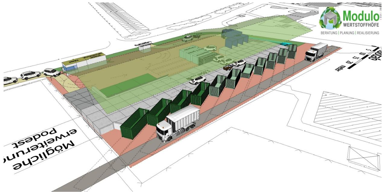
Der LKW-Verkehr ist so positioniert, dass der LKW-Fahrer den Container möglichst von links aufnehmen kann.
