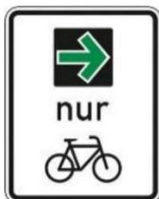
Um den rechtsabbiegenden Radverkehr an Knotenpunkten zu beschleunigen, steht mit dem Inkrafttreten der StVO-Novelle 2020 ein Verkehrszeichen zur Verfügung, das ein Rechtsabbiegen bei „Rot“ ausschließlich für den Radverkehr zulässt. Es sollte für das gesamte Stadtgebiet geprüft werden, ob eine entsprechende Beschleunigung des Radverkehrs möglich ist. Die Voraussetzung ist dabei eine reine Rechtsseitigkeit bei der Radverkehrsführung.
