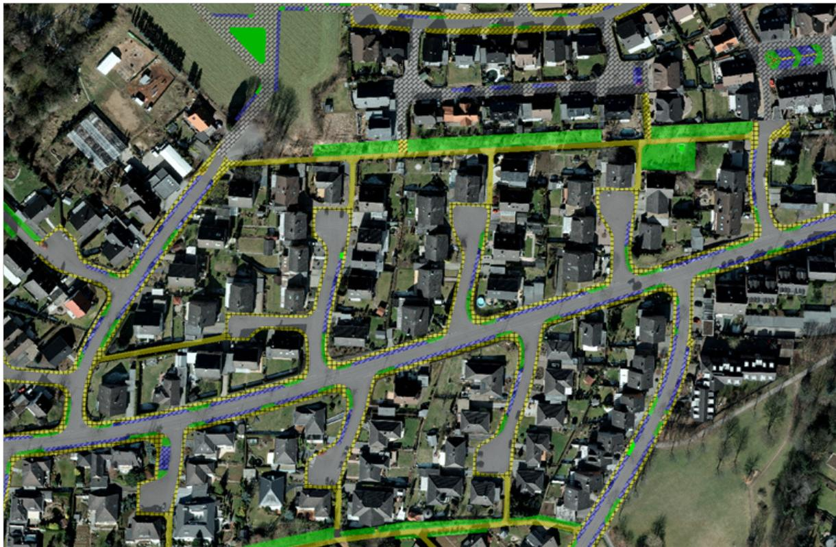
Abb. 3: Flächenmodell mit Darstellung der Flächennutzung und der Befestigungsart
