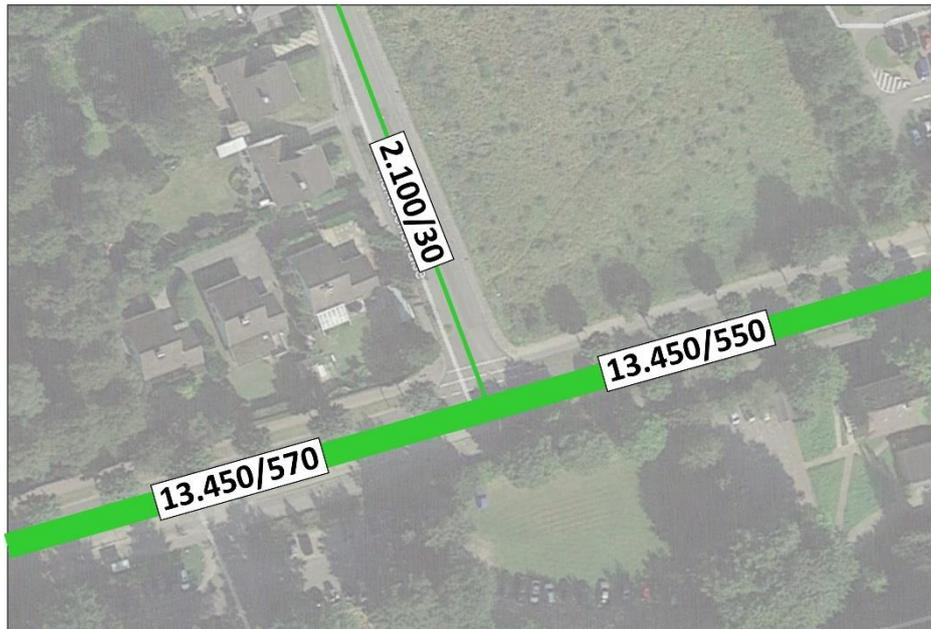
Bild 2.4: Durchschnittliche Tagesverkehrsstärke 2017 (DTV,  $DTV_{sv}$ )
