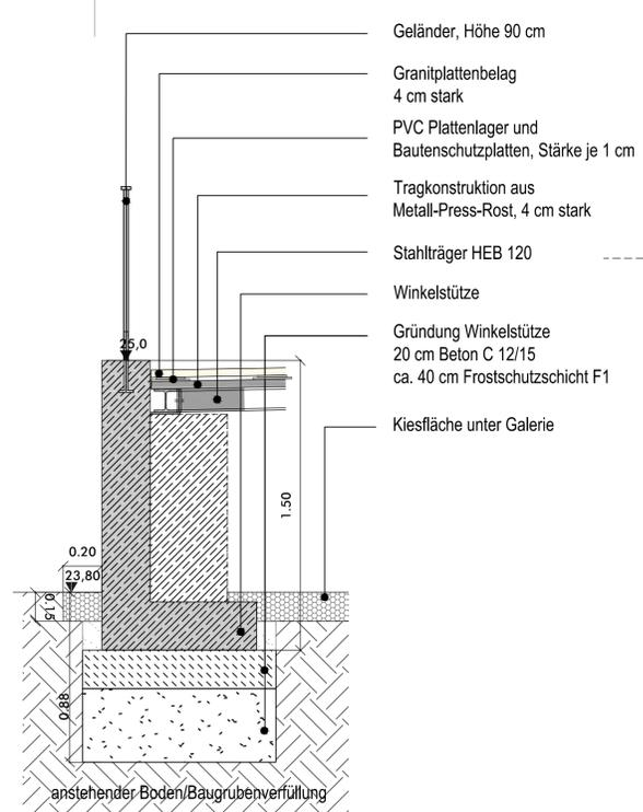
Schnitt durch Längsriegel Winkelstütze mit Gründung
