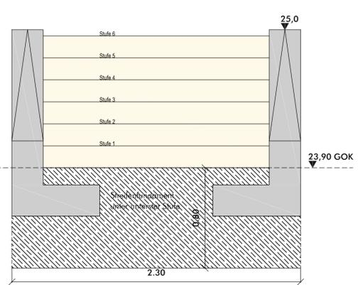
Schnitt durch Streifenfundament mit Ansicht Stufenanlage
