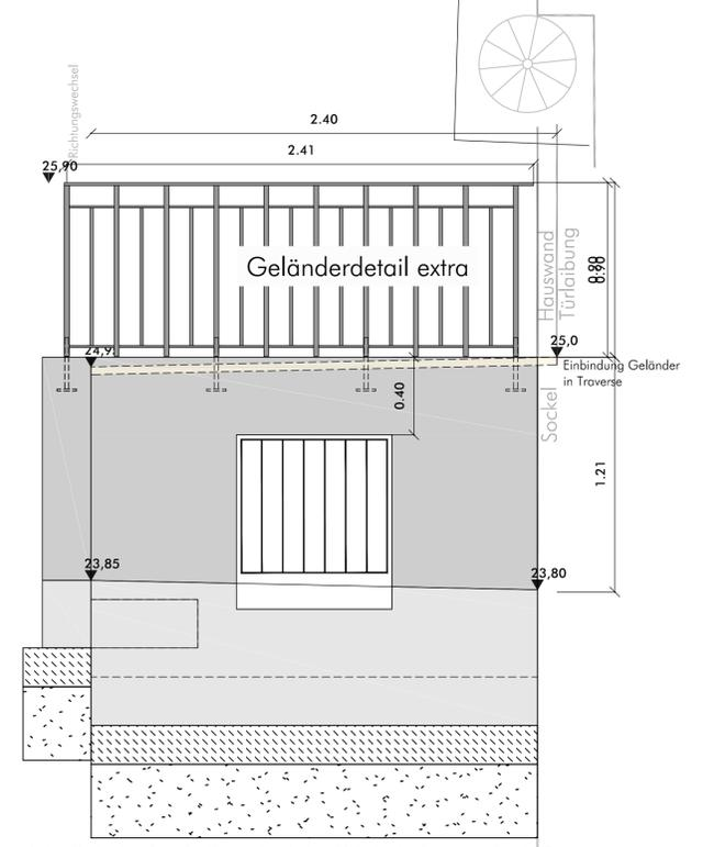
Ansicht-Schnitt durch Querriegel der Winkelstützwand mit Fenster
