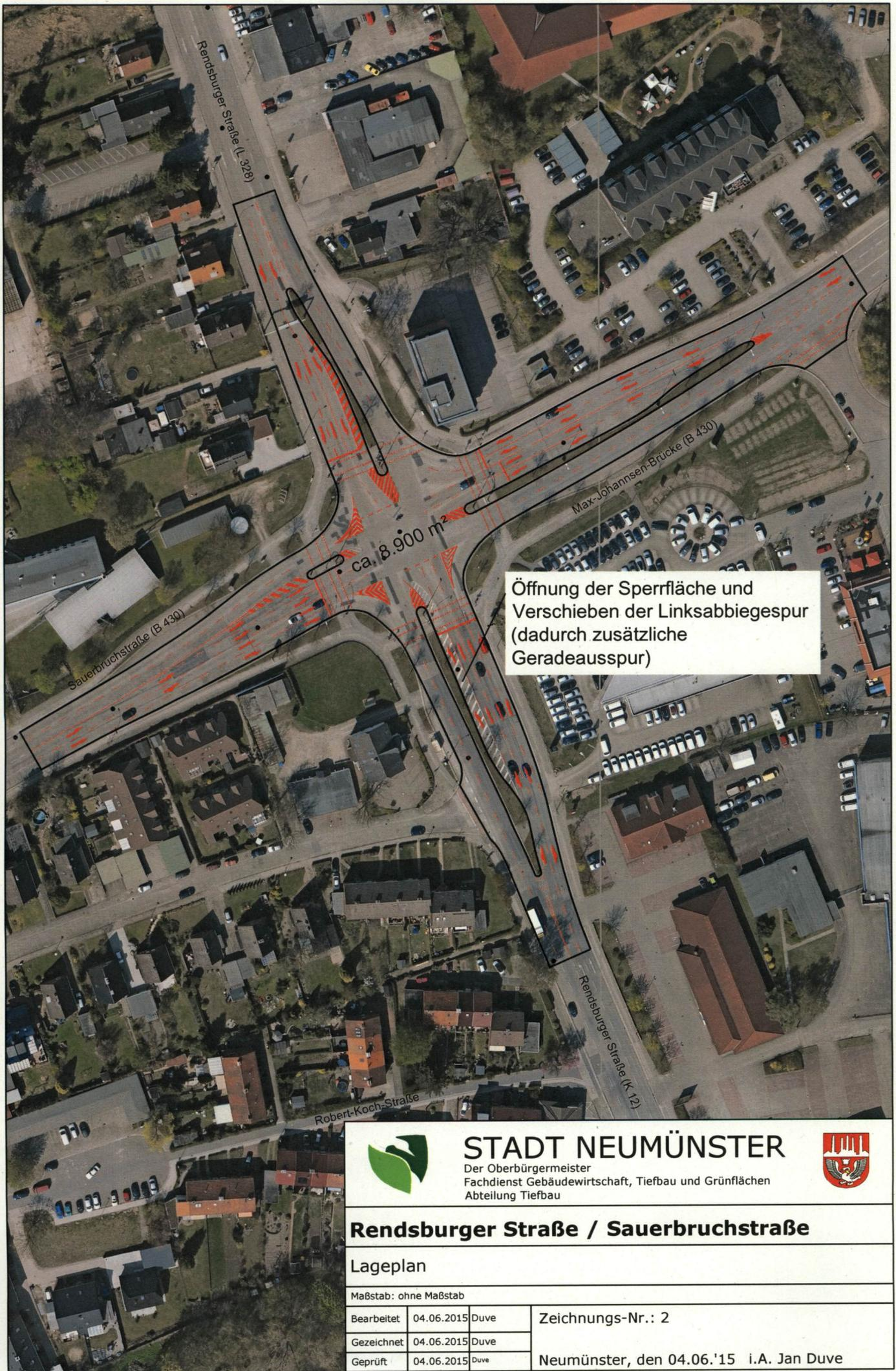
Öffnung der Sperrfläche und Verschieben der Linksabbiegespur (dadurch zusätzliche Geradeauspur)
