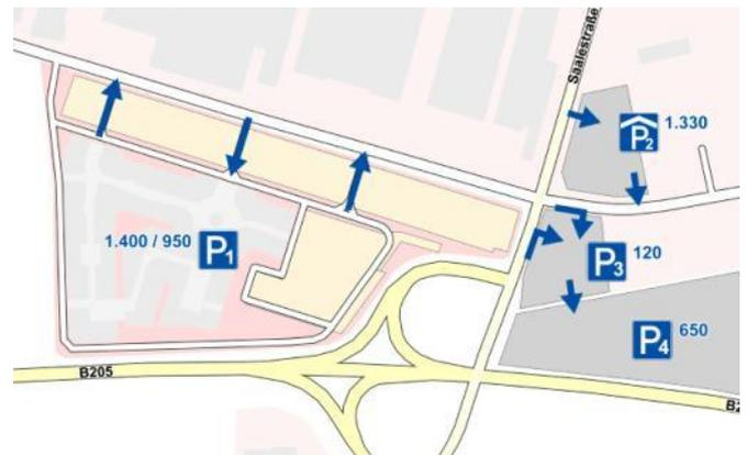
Mit einer weitergehenden Anpassung der Signalsteuerung in Form einer geänderten Verteilung der Freigabezeiten können auch diese Verkehrsstärken an dem dann insgesamt um rund 500 Kfz/h höher belasteten Knotenpunkt „Oderstraße / Saalestraße“ leistungs- und qualitätsgerecht abgewickelt werden.
