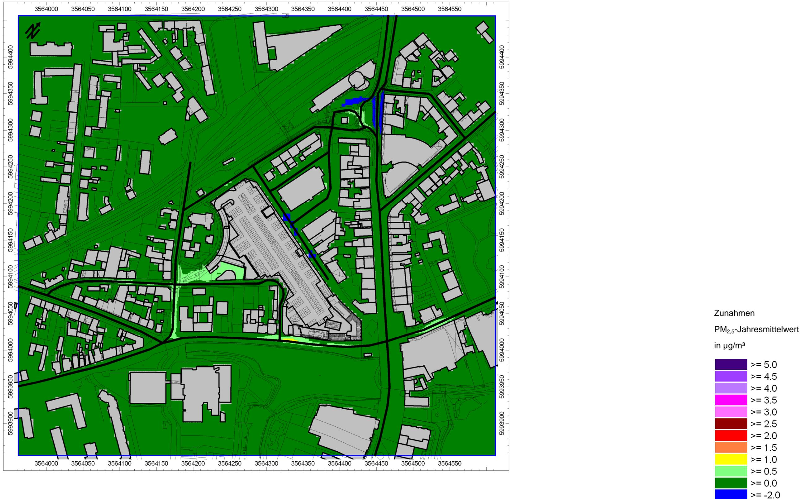
**A 7.4.4 Prognose-Nullfall 2, Aufpunkthöhe Erdgeschoss, Maßstab 1: 3.000**
