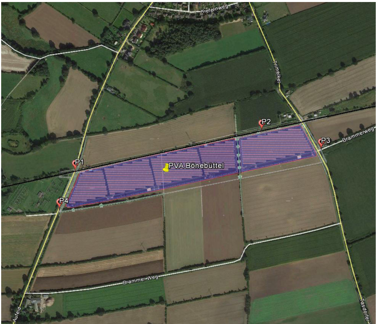
Bild 3.5.1: Exemplarisch gewählte Messpunkte (P1- P4) für die Analyse der Reflexionen (Quelle: Google Earth/SolPEG)
