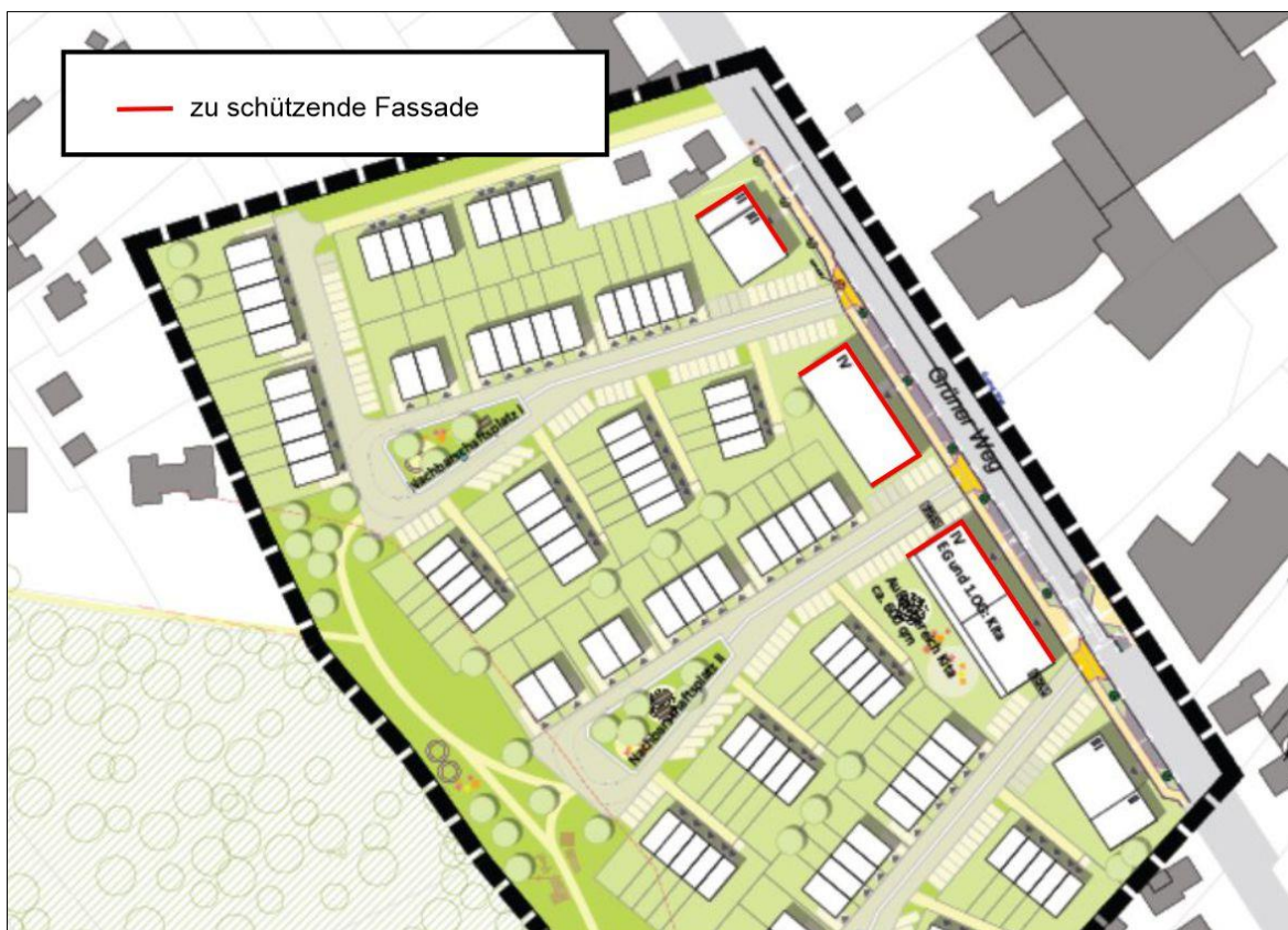
Abb. 5.2: Fassaden mit architektonischen Lärmschutzmaßnahmen
