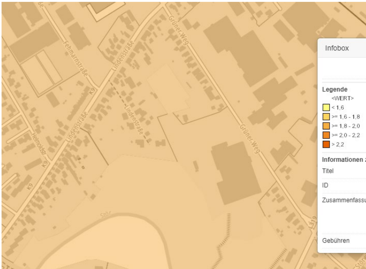
Abbildung 4 Kartenausschnitt aus dem Umweltportal des Landes Schleswig Holstein. Dargestellt ist die mittlere Wärmeleitfähigkeit in W/m^{\circ}K für Bohrtiefen zwischen 0 - 100 m Tiefe.
